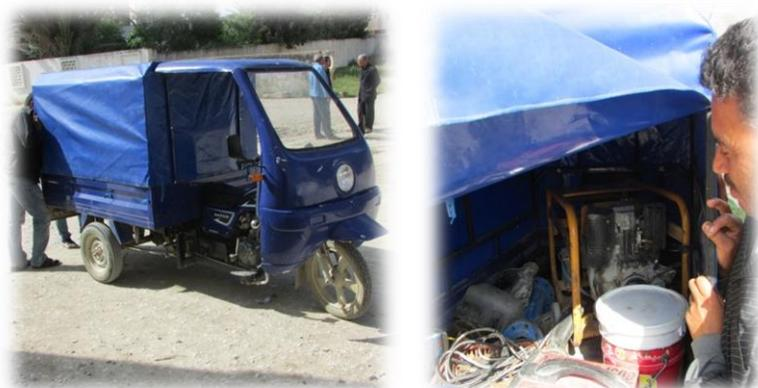
Du côté des GDA, nous assistons à un renforcement de leurs capacités et autonomie en matière de maintenance à travers l'achat de petits matériels (poste soudeur, groupe électrogène, caisse à outils, meule à disque) et un petit moyen de transport (tricycle au niveau du GDA El Ouifeq) pour les déplacer aux lieux de travaux.
