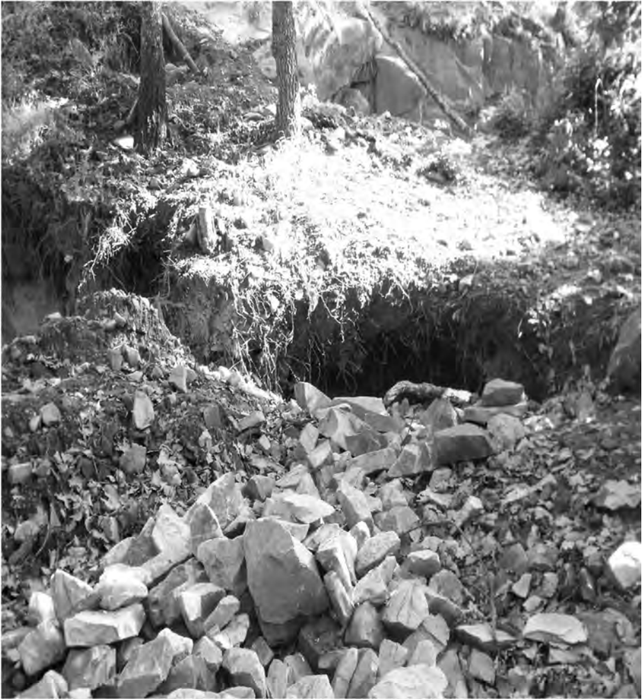
Photo 2 – Crevasse provoquée par l'extraction de pierres
