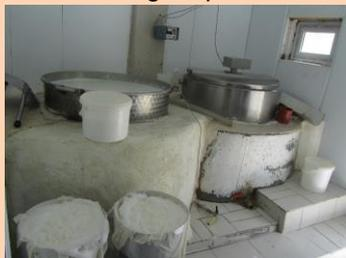
Les cuves de pasteurisation/chauffage du lait/lactosérum à Vithkuq
