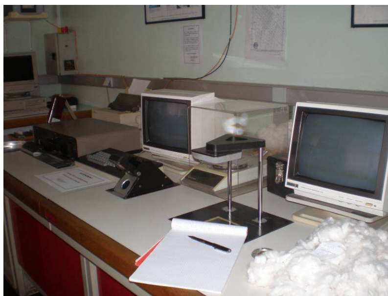
Figure 12: Chaîne HVI du service de classement et contrôle de qualité du coton de la SOFITEX, Bobo-Dioulasso (Burkina Faso)
